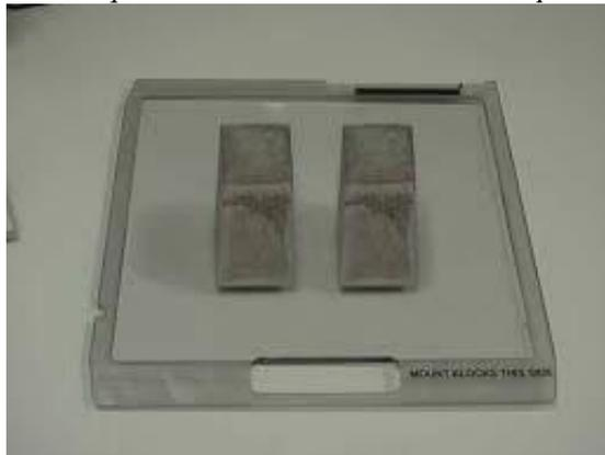
*FIG. 3.11. Bloques de cerrobend utilizados como protección, para atenuar el haz AP y PA.*
