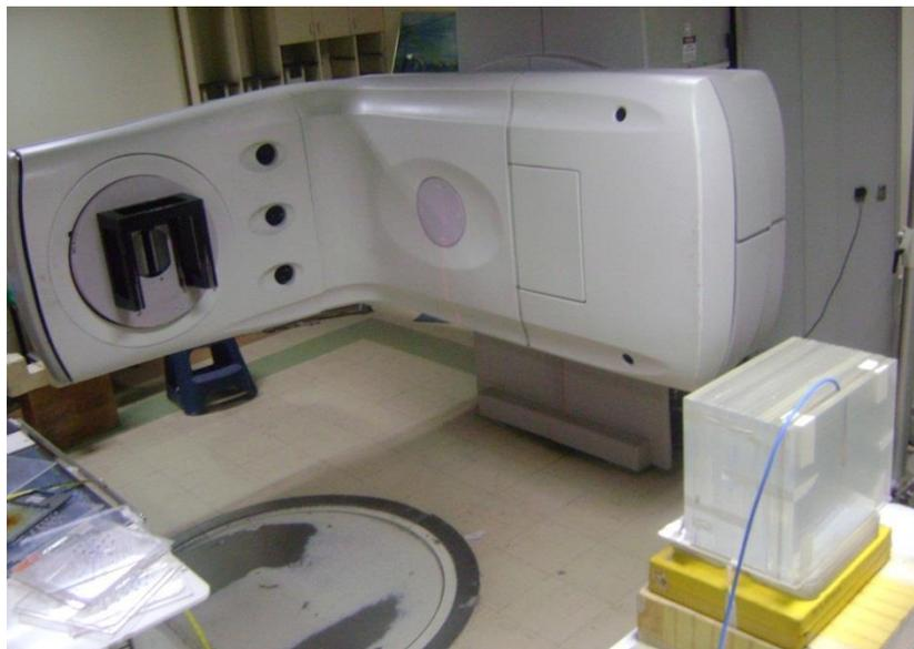
*FIG. 3.13. Arreglo experimental utilizado para obtener las curvas de PDP en acrílico a 300 cm*
