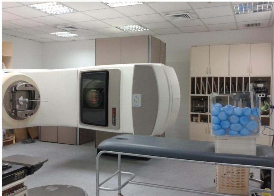
*FIG. 3.15. Sistema experimental para medir la dosis en entrada, salida y pulmones en un fantoma simulador de tórax*
