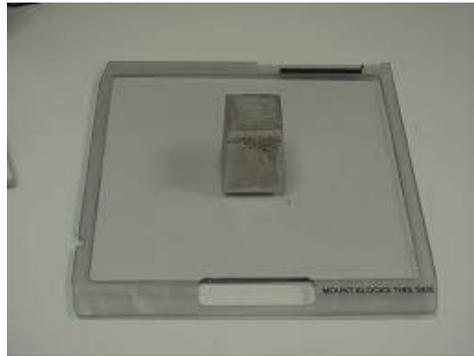
*FIG. 3.10. Bloque de cerrobend utilizado como protección.*
