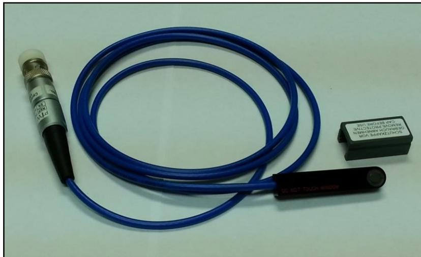
Figura A.2. 2: Cámara de ionización Soft X ray de 0.0053 cm<sup>3</sup> de marca PTW.
